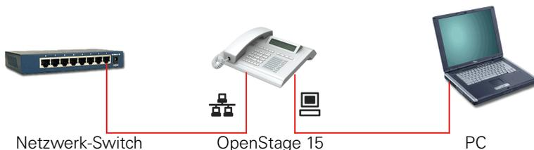
Durch diese Anschlussart sparen Sie jeweils einen Netzwerk-Anschluss des verwendeten Switches und benötigen bei entsprechender Anordnung weniger Netzwerk-Kabel bzw. nutzen kürzere Leitungswege.
